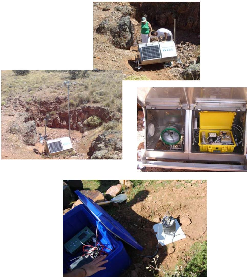
Figura 3.19 Estación receptora de emisión de gases y sismómetro portátil
